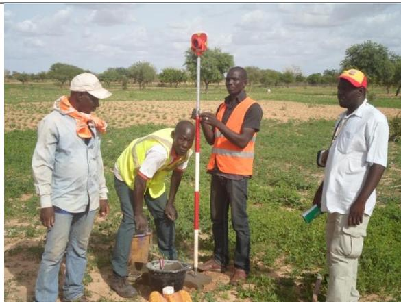
Photo N°4 : Prise des coordonnées d'une borne
