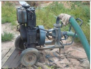
Photo 2 : Utilisation de motopompe pour le prélèvement de la ressource.
