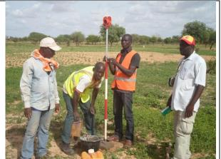
Photo N°4 : Prise des coordonnées d'une borne
